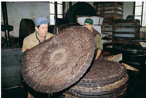
Extendiendo los capachos en la pila de la almazara tradicional; entre uno y otro se coloca la pasta de olivas ya trituradas (Foto: J. Pellicer)
