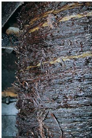
La pila de capachos con pasta de olivas comienza a rezumar aceite una vez se inicia el prensado (Foto: J. Pellicer)
