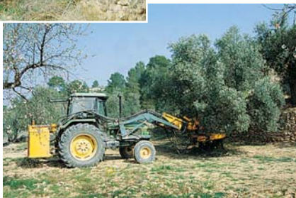
Arriba, el vareo tradicional de la oliva, con la red de recogida; abajo, una vibradora, el moderno sistema de recogida (Fotos: J. Pellicer)
