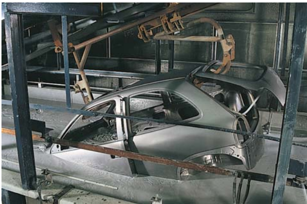
Todos los vehículos reciben, por inmersión, una protección anticorrosiva que se proporciona mediante electrólisis
