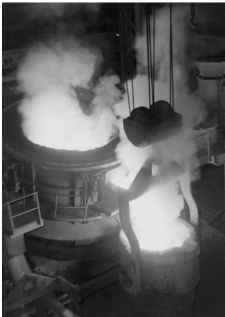
Colada del borno de ferromanganeso en las instalaciones de Hidro-Nitro, en Monzón
