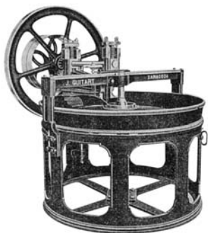
Macerador de palanca giratoria de pasta para fideos
